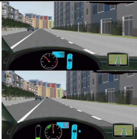
Figure 1. Simulateur éco 2 (Fig. 1a) et tableau de bord avec les guidages visuels et un environnement routier virtuel en temps réel (Fig. 1b et 1c, logiciel SCANNER). Tâche préalable de détection périphérique (Fig. 1d)
