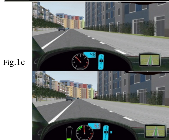
Figure 1. Simulateur éco 2 (Fig. 1a) et tableau de bord avec les guidages visuels et un environnement routier virtuel en temps réel (Fig. 1b et 1c, logiciel SCANNER). Tâche préalable de détection périphérique (Fig. 1d)
