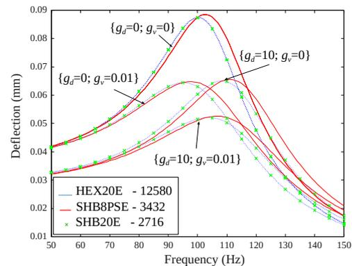
Fig 4. Réponse fréquentielle autour du 1<sup>er</sup> mode de flexion évaluée au centre de la plaque
