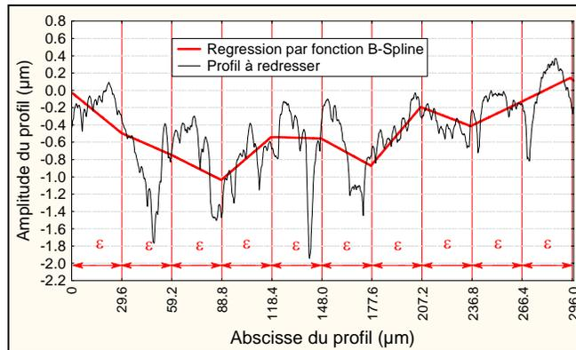
Figure 2. Régression du profil par une fonction B-Spline
