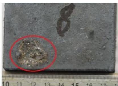
Figure 1 - Vue de dessus d'un défaut de céroxide.
