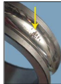
Figure 2 - Défaut de la bague intérieure d'un roulement à billes [9]
