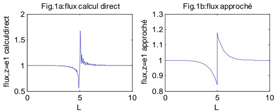
test2  $L=10$   $e=1$   $e_1=0.5e$ ,  $b=0.5L$ ,  $R_0=0.2$ ,  $\lambda=1$ , ( $W \cdot m^{-1} \cdot K^{-1}$ )  $Q=1$  ( $W \cdot m^{-2}$ ) .
