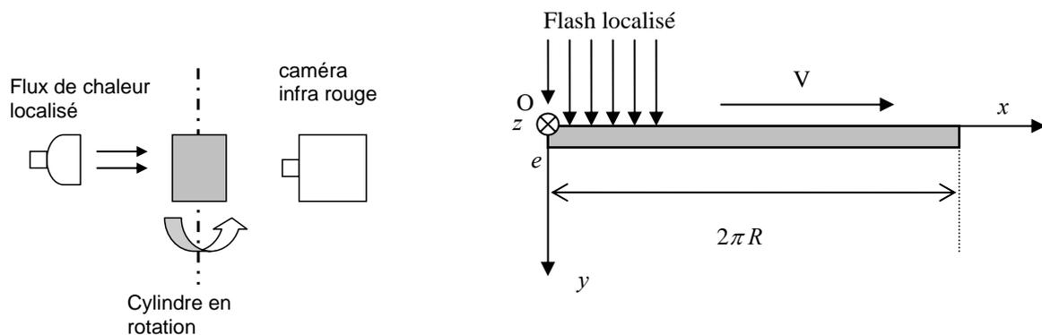
Figure 1 : Schéma du dispositif expérimental et modèle 2D associé
