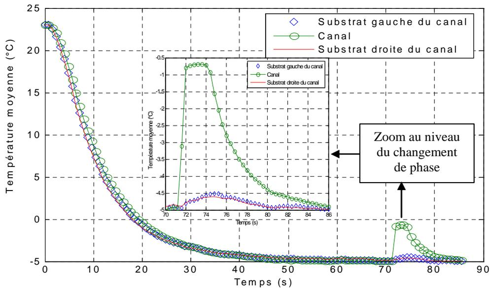
Figure 2 : Evolution temporelle de la température moyenne dans et de part et d'autre du canal
