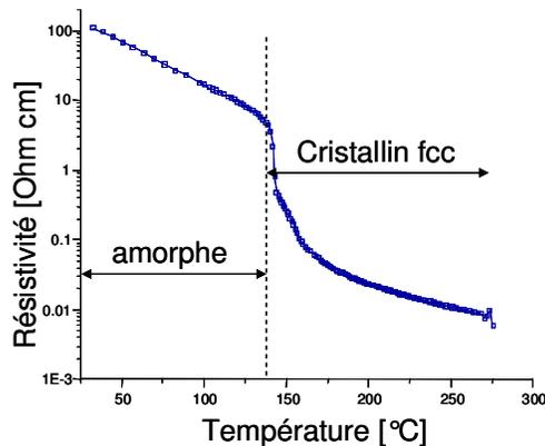
Figure 1 : Variation de la résistivité électrique en fonction de la température pour un Ge<sub>2</sub>Sb<sub>2</sub>Te<sub>5</sub> (mesures réalisées par méthode de Van der Pauw [4]).
