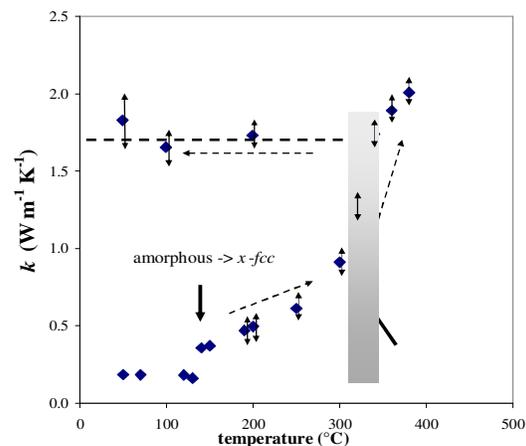
Figure 2 : Conductivité thermique du Ge<sub>2</sub>Sb<sub>2</sub>Te<sub>5</sub> mesurée par radiométrie photothermique modulée sur la plage de température 50 - 400°C..
