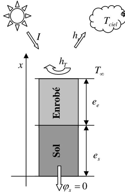
Figure 1 : Représentation des conditions aux limites utilisées dans la modélisation de l'échange thermique entre l'enrobé et son environnement
