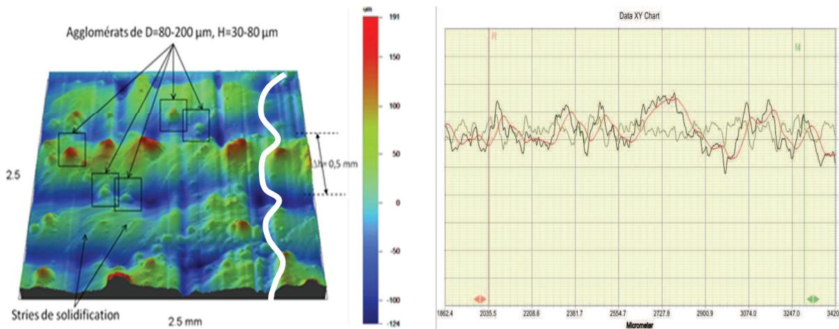
Figure 3 : (a) topographie 3D d'une surface élaborée par FDPL (présence d'ondulation W et de rugosité R), (b) profil de rugosité d'un mur avec distinction de R et W
