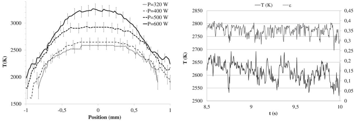
Figure 7 : (a) Evolution de la température en fonction de la largeur du Bain liquide (pyrométrie 2D à bande spectrale) (b) Evolution de la température et de l'émissivité  $\epsilon$  au cours du temps pour  $P=600 \text{ W}$ ,  $D_m=1.1 \text{ g/min}$  et  $V=0.4 \text{ m/min}$  (pyrométrie spectrale)
