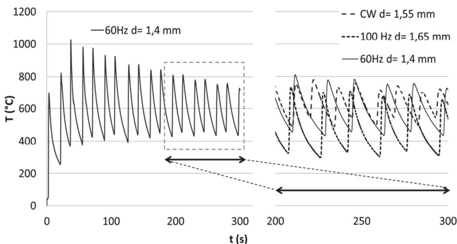
Figure 5 : Températures du substrat mesurées par thermocouples (à distance  $d$  de la 1<sup>ère</sup> couche) pour différents régimes (continu, pulsé 60Hz et pulsé 100 Hz) pour une température moyenne de 400 W
