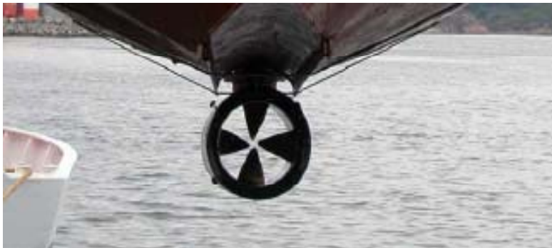
Norpropeller - Brunvoll Machine radiale de 100kW, bobinage fractionnaire, refroidie à l'eau, sans moyeu
