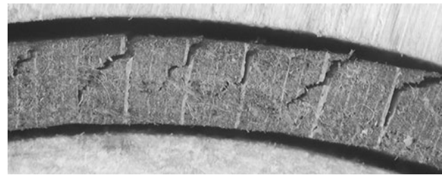
Fig. 4 Lateral view of checked beech veneer under the microscope Abb. 4 Mikroskopische Aufnahme von gerissenem Buchenfurnier. Seitenansicht
