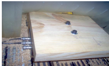
Figure N°3 Fixation de l'éprouvette sur la défonceuse.
