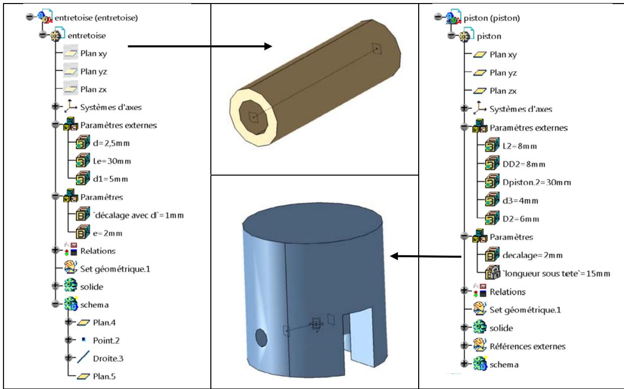
Figure 6. Structure des pièces entretoise et piston.
