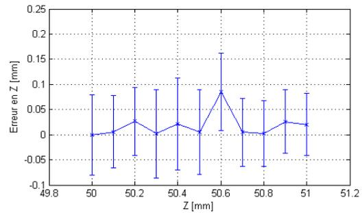
Figure 4: Mesure de l'erreur suivant l'axe  $Z$  ( $X = 0, Y = 100mm$ ) et écarts types associés.
