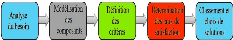
Fig. 1: Synoptique de la méthode d'optimisation utilisée
