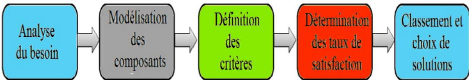
Fig. 1: Synoptique de la méthode d'optimisation utilisée
