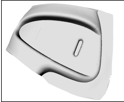
Figure 17. Polyèdre initial et résultat de l'identification des lignes caractéristiques.
