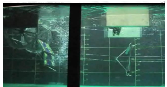
Fig. 10 Photo du prototype, vue de dessous : une voile ouverte à droite, une voile en cours d'ouverture à gauche
