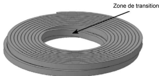
FIGURE 2 – Géométrie d'une « double galette »
