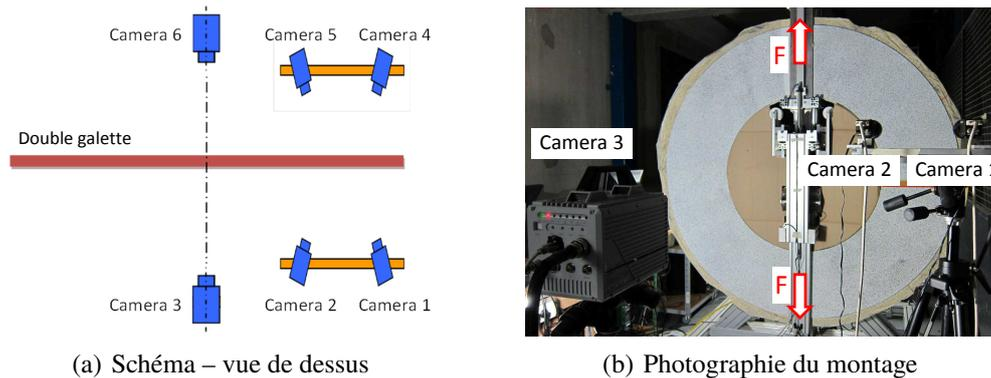
FIGURE 3 – Dispositif expérimental.
