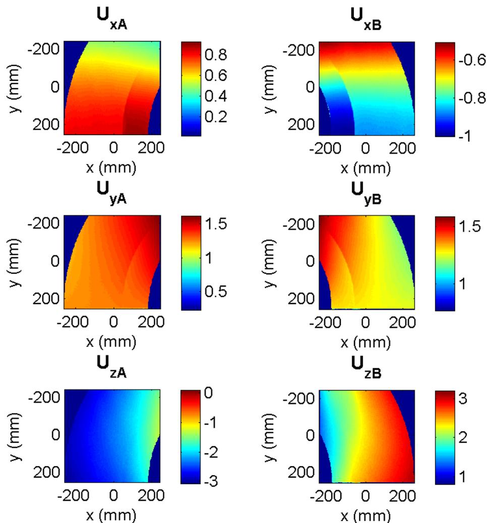
FIGURE 6 – Observation des cartes de déplacements par les caméras 1, 2 et 4, 5 pour un effort de 175 kN ; délaminage important sur les deux faces de la double galette.
