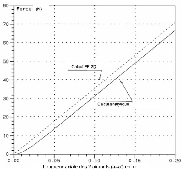
Figure III.36 : Force en fonction de  $a=a'$  pour le 1<sup>er</sup> cas test.
