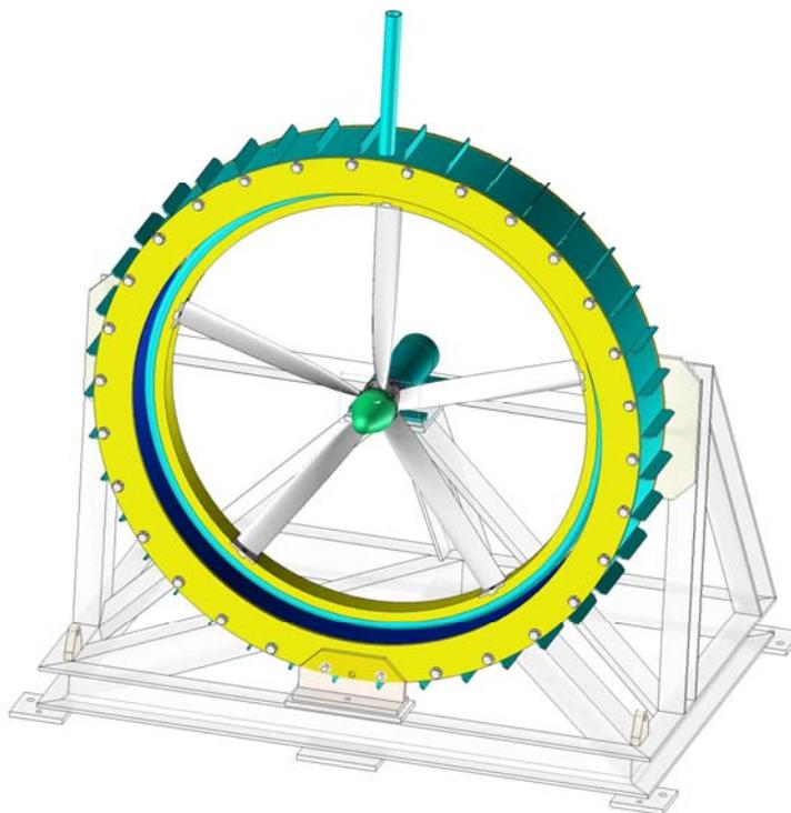
Figure IV.1 : Vue de la CAO du démonstrateur d'hydrolienne RIM-Driven
