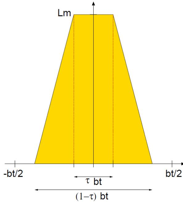
Figure III.18 : Géométrie d'un pôle rotorique trapézoïdal [94]
