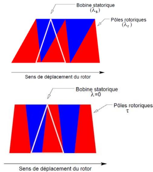
Figure III.17 : pôles rotoriques rectangulaires et trapézoïdaux [94]
