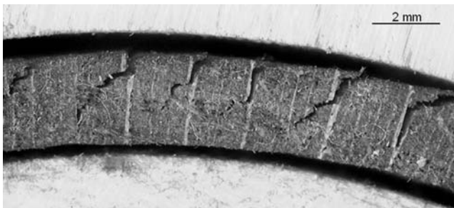
Fig. 1 Lateral view of checked veneers under the microscope Abb. 1 Seitenansicht von gerissenen Furnieren unter dem Mikroskop
