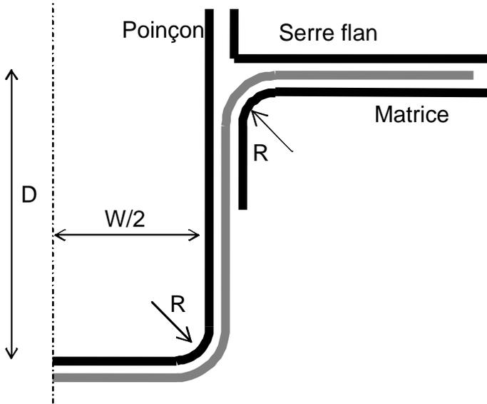
**Figure. II.** Géométrie de l'essai en « Oméga ».
