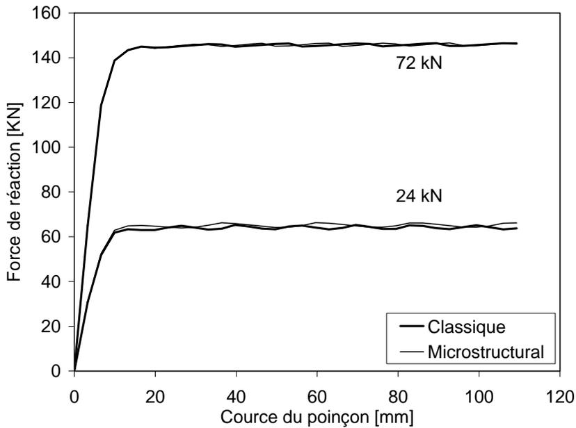
**Figure. V.** Force de réaction du poinçon.
