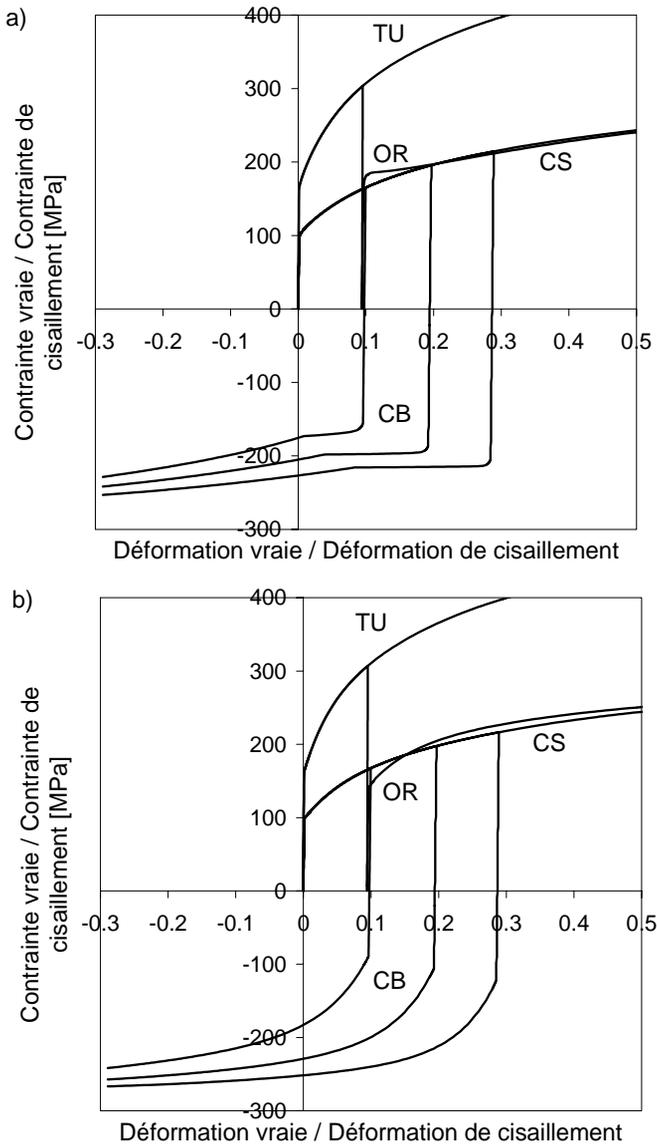
**Figure. I.** Prédications rhéologiques avec a) le modèle microstructural de Teodosiu et Hu et b) le modèle classique de Chaboche. TU : traction uniaxiale ; CS : cisaillement simple; CB : cisaillement Bauschinger à 10, 20 et 30% de pré-déformation ; OR : traction uniaxiale à 10% de pré-déformation suivie d'un cisaillement simple dans la même direction.
