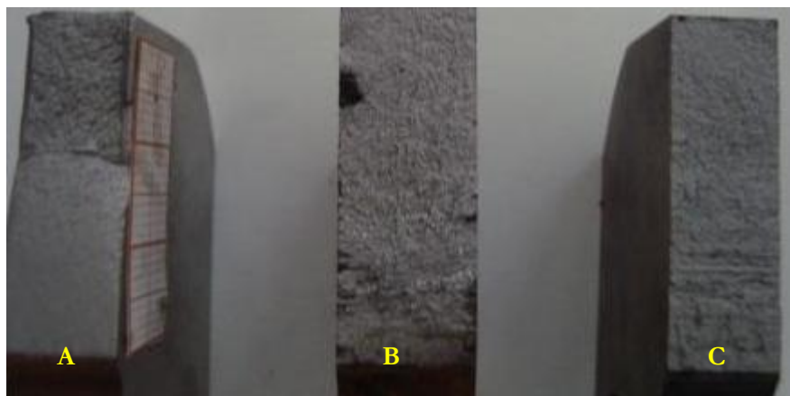
FIGURE 3 : morphologie des surfaces des éprouvettes CT après essai de fatigue pour l'acier 17-4 PH, A) matériau de base B) matériau corrodé C) matériau nitruré.
