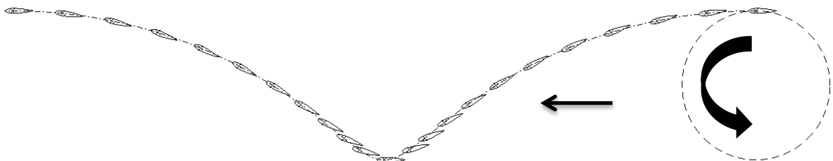
Figure 3. Exemple de trajectoire d'un propulseur à axe transverse en mode trochoïdal.
