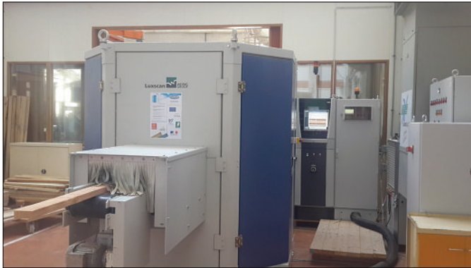
Photo 1 Scanner d'analyse optique et rayons X de l'ENSAM de Cluny
