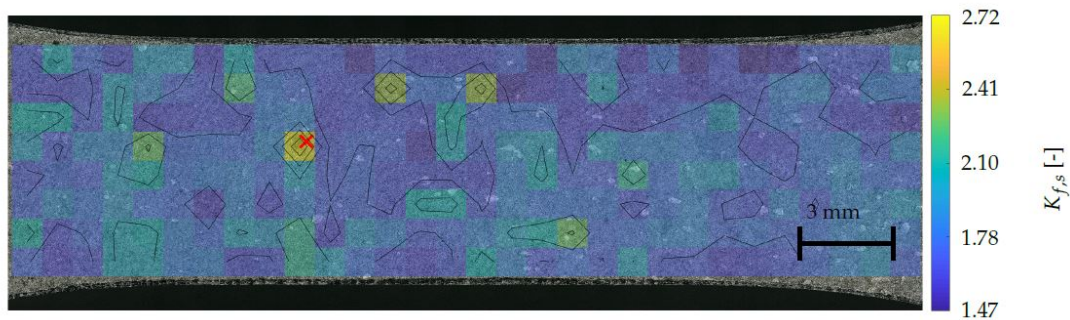
FIGURE 2.3 – Exemple de carte surfacique représentant le facteur de sensibilité à l'entaille calculé en surface pour la fatigue K_{f,s} [Pomberger et al., 2020b].
