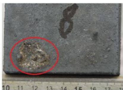
Figure 1 - Vue de dessus d'un défaut de céroxide.
