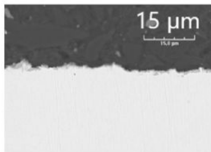
Figure 2 - Coupe d'une pièce en acier dans une zone ne présentant pas de céroxide (MEB - détecteur BSE).
