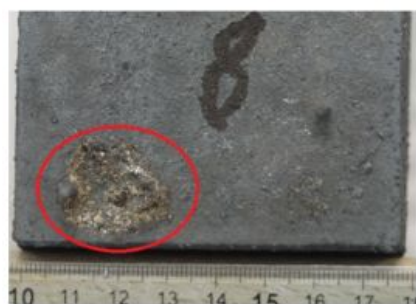
Figure 1 - Vue de dessus d'un défaut de céroxide.
