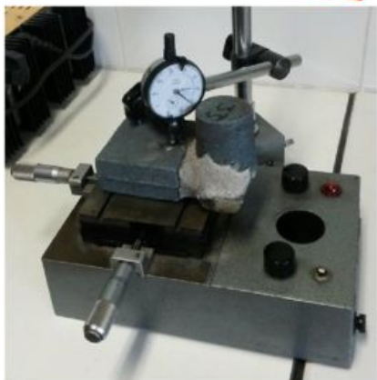
Figure 7 - Dispositif de mesure de la profondeur des céroxides.
