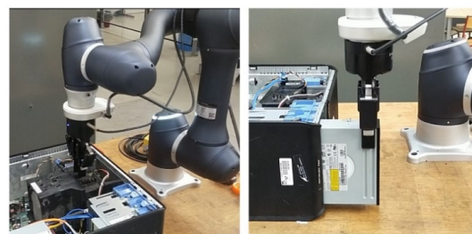
f. démontage robotisé
