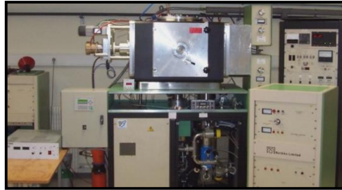
Figure 2: Bâti de pulvérisation magnétron
