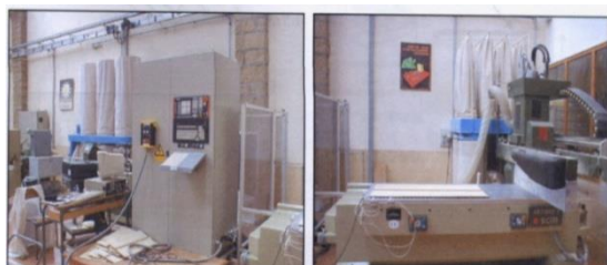
Fig.2. Défonceuse à commande numérique à trois axes.
