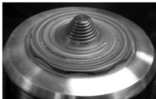
Figure 3. Outil FSW en PCBN avec un épaulement convexe comportant un scroll [4].
