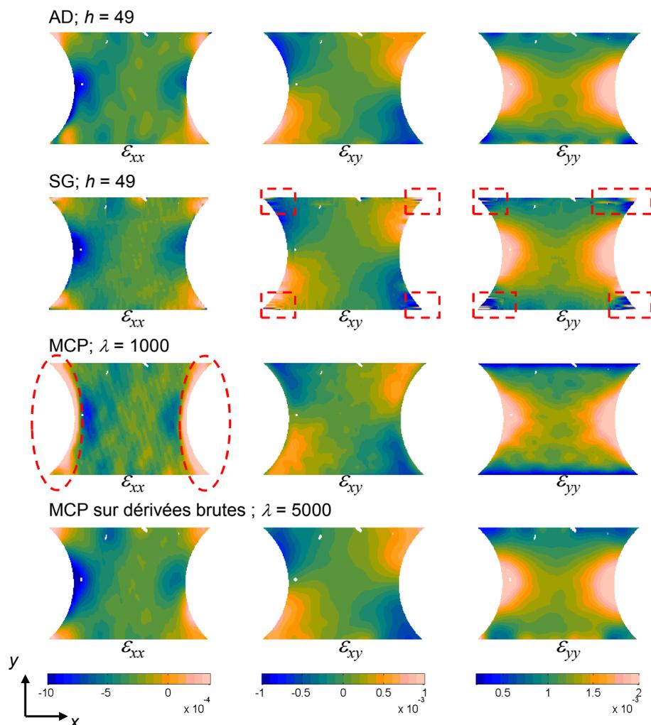
FIGURE 5 – Cartes de déformations expérimentales obtenues à l'aide des différentes procédures de lissage pour l'éprouvette entaillée sollicitée en traction (taille de la région d'intérêt :  $16 \times 23 \text{ mm}^2$ ).
