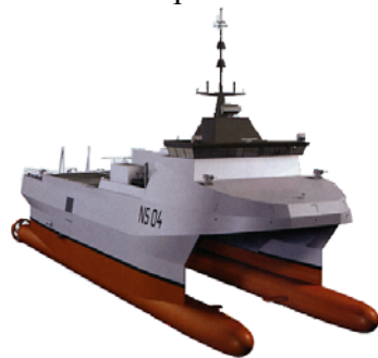
Figure III.28 : Illustration et cahier des charges d'un projet de navire concept SWATH militaire (d'après Cols Bleus n° 2727 du 24/12/04)
