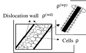
FIG. 1. Représentation de la microstructure intragranulaire – Peeters (2002)
