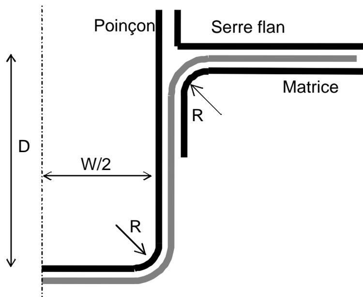
Figure 2. Géométrie de l'essai en « Oméga ».
