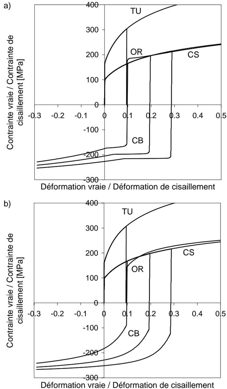
**Figure 1.** Prédications rhéologiques avec a) le modèle microstructural de Teodosiu et Hu et b) le modèle classique de Chaboche. TU: traction uniaxiale ; CS: cisaillement simple; BS: cisaillement Bauschinger à 10, 20 et 30% de pré-déformation ; OR: traction uniaxiale à 10% de pré-déformation suivie d'un cisaillement simple dans la même direction.
