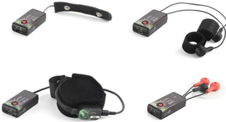
Figure 35 : Capteurs TEA interfacés avec le dispositif (de haut en bas puis de gauche à droite : ECG, GSR, Air Flow, EMG).
