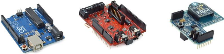
Figure 11 Cartes électroniques permettant la capture et la transmission des données physiologiques.
