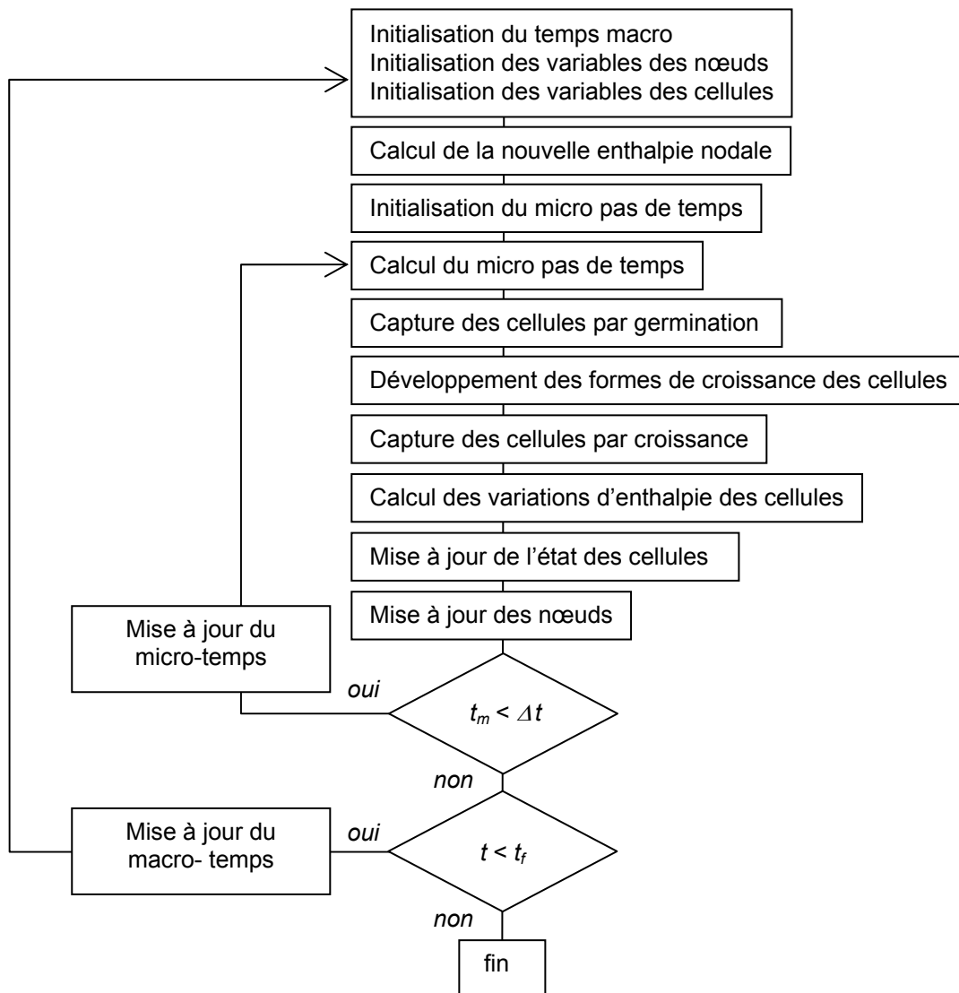
Figure 4 : Algorithme du modèle couplé automates cellulaires / éléments finis
