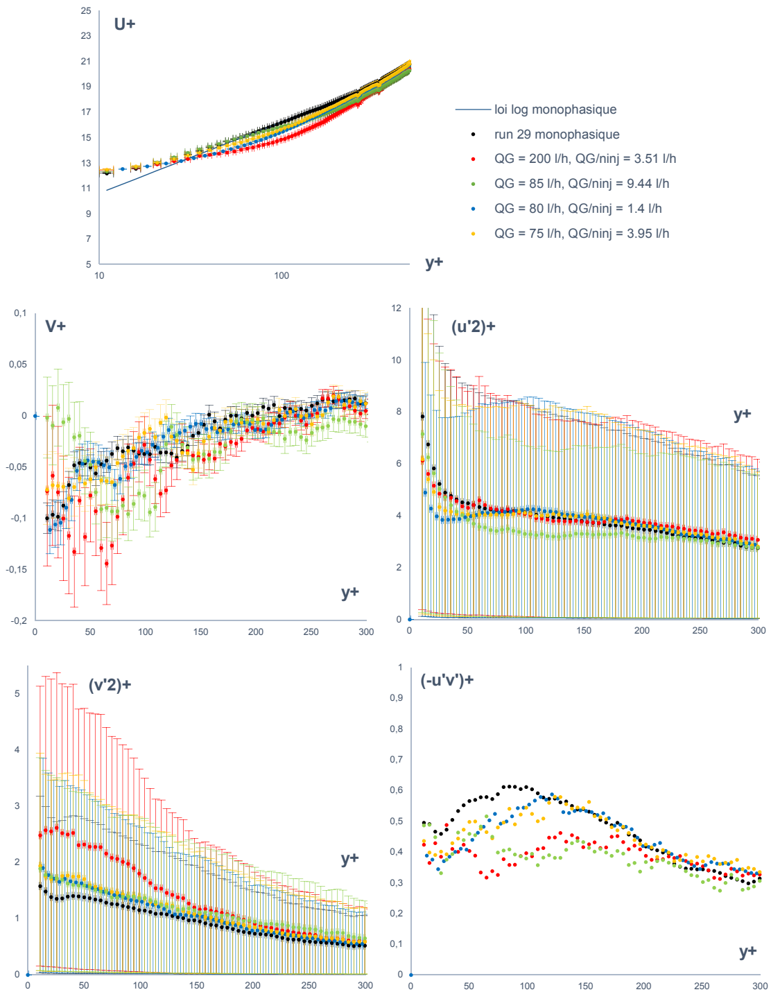
Figure 4.1 Profils de vitesse mesurés par PIV dans la région logarithmique (respectivement: vitesse longitudinale moyenne, vitesse verticale moyenne, tension de Reynolds longitudinale, tension de Reynolds verticale et frottement turbulent)
