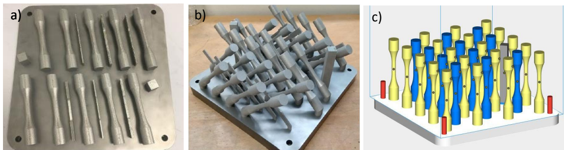
FIGURE 3.6 – Plateau correspondant à chaque orientation de fabrication.
