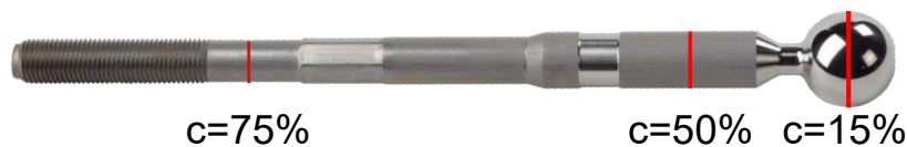
FIGURE 1.11 – Exemple de composant extrudé à froid : pivot de direction, illustrant les différents niveaux de corroyage le long du composant. Photo :entreprise Gevelot.
