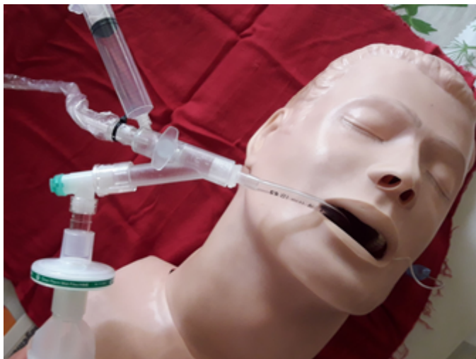
Figure 3 : Ligne d'intubation sur mannequin physiologique avec la vanne développée
