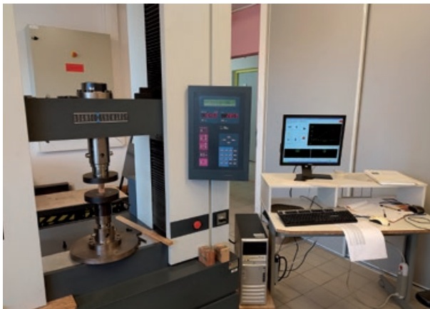
Photo 7. Banc d'essais de compression. Compression test bench. Photo D. Dougabka.
