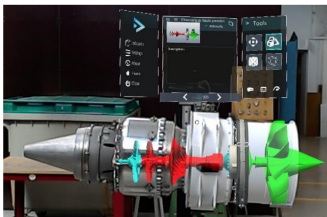
Figure 14. AR Hololens turbofan scenario.
