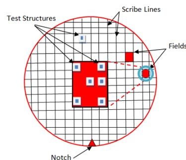
Fig.1 description des tranches de 300 mm de diamètre
