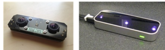
Figure 1: Carte électronique du Leap Motion (à gauche) et dans son boîtier (à droite).
