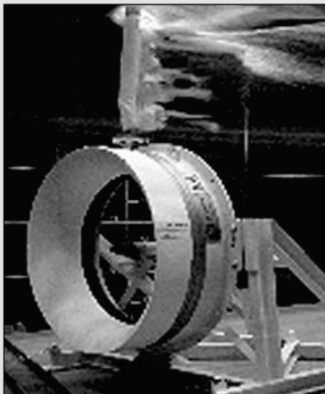
Figure 6 : Essais d'un prototype d'hydrolienne "rim-driven" par l'Institut de recherche de l'École Navale. Source IRENav.
