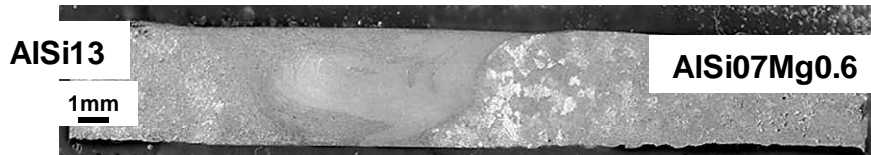
FIG.8 – Macrographie de la soudure FSW AlSi7Mg0.6 sur AlSi13 moulés
