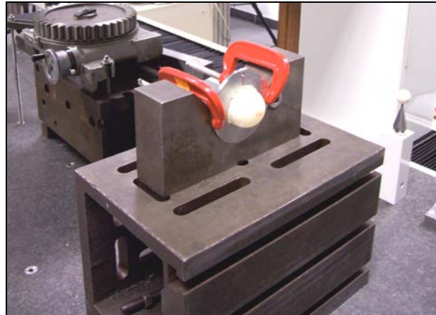
Figure II : Présentation de la mise en position d'un explant sur la Machine à Mesurer Tridimensionnelle
